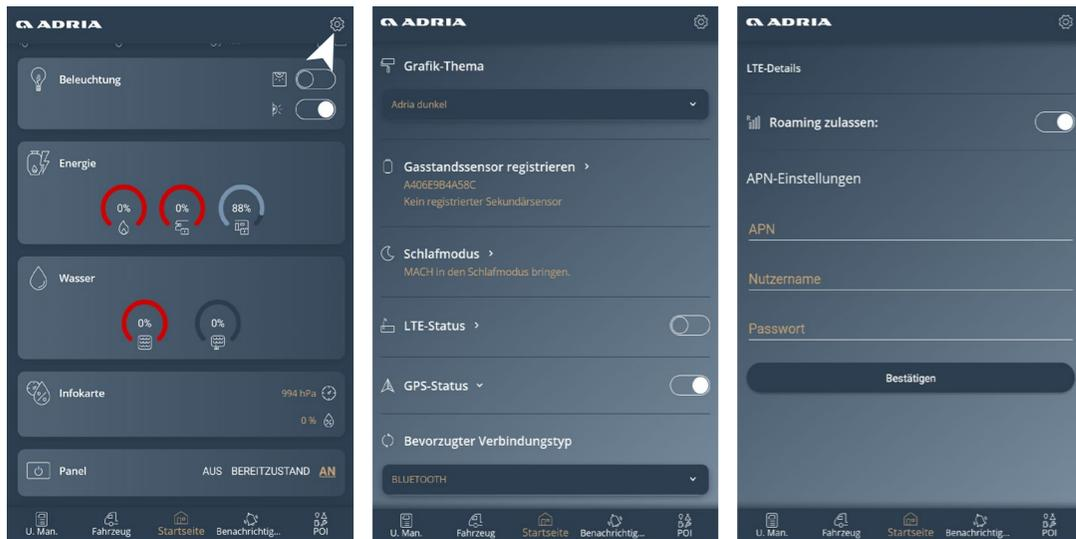
Falls eine Minute nach dem Einlegen der SIM-Karte keine Internetverbindung besteht, müssen Sie Ihre APN-Daten (Access Point Name) manuell in die MACH-App eingeben. Bitte beachten Sie, dass diese Daten für jeden Internet Service Provider spezifisch sind.
