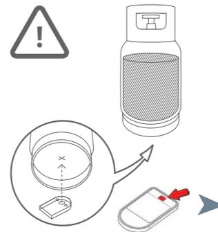
Bringen Sie den Sensor, wie in der Abbildung ersichtlich, am Boden der Gasflasche an. Die Befestigung des Sensors funktioniert nur bei magnetischen Metall-Gasflaschen.
