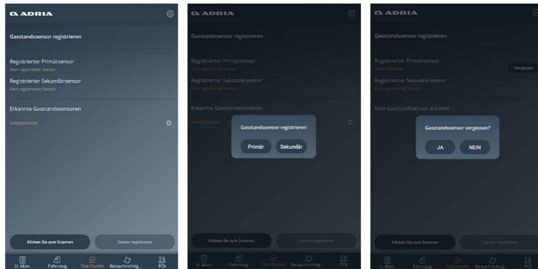
Jeder Gassensor muss innerhalb der MACH-App verkoppelt und entkoppelt werden. Sie können bis zu zwei Gassensoren koppeln, primär und sekundär.
