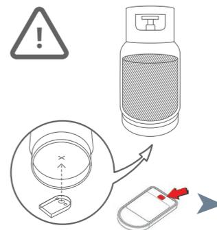
Befestigen Sie den Sensor an der Unterseite der Gasflasche, wie in der Abbildung gezeigt. Die Befestigung des Sensors funktioniert nur bei magnetischen Gasflaschen aus Metall. ACHTUNG: Bitte denken Sie daran, beim Wechsel der Gasflaschen den Sensor an der neuen, vollen Gasflasche zu befestigen.
