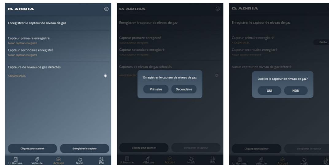
Chaque capteur de gaz doit être associé à l'application MACH. Vous pouvez connecter jusqu'à deux capteurs, l'un principal, l'autre secondaire.
