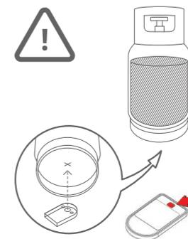
Fixez le capteur en bas de la bouteille de gaz, comme indiqué sur l'image. La fixation du capteur ne fonctionne que sur les bouteilles de gaz métalliques magnétiques.
