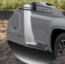
AJONEUVOA MYÖTÄILEVÄ SIVUVERHOILU (OHJAAMON ASKELMA LISÄVARUSTEENA)
