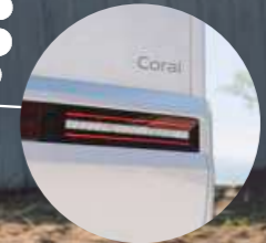
KÄLLISTETTU TAKASEINÄ ILMANOHJAIMELLA JA LED-VALOILLA
