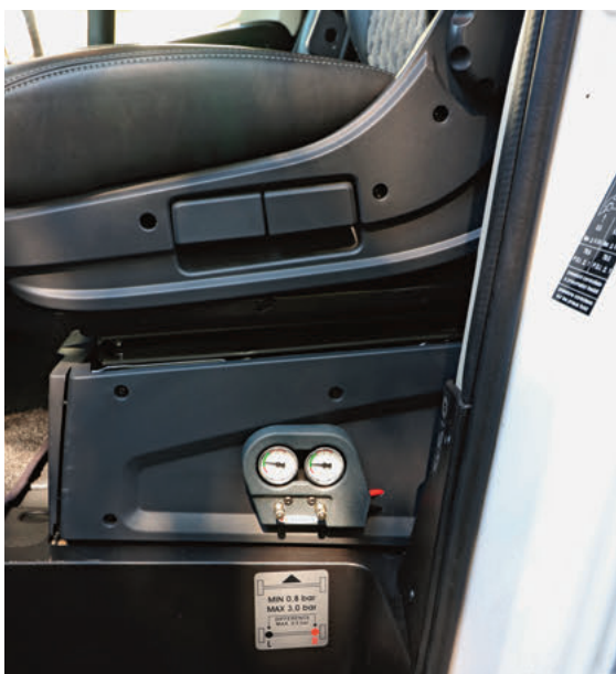
Kontrollinstrumente für den richtigen Wert der Hinterachs-Luftfederung.
