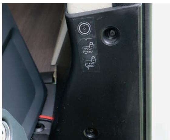
Système de commutation bien réalisé pour le réservoir d'eaux usées dans la zone de la porte conducteur.
