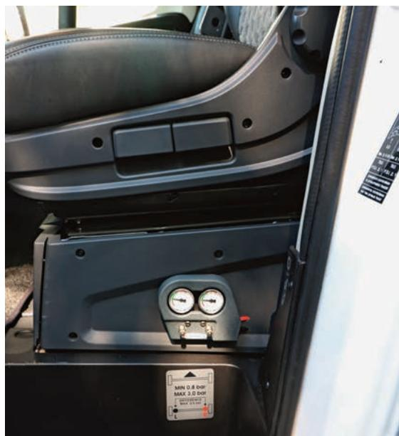
Instruments de commande pour bien régler la suspension pneumatique de l'essieu arrière.
