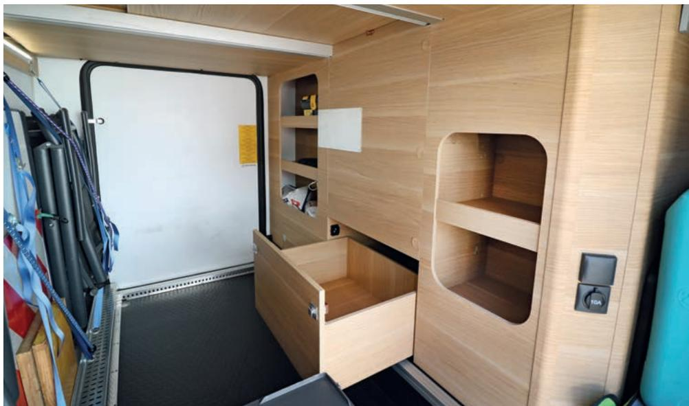
Revêtement de sol facile d'entretien et rails avec œillets de fixation dans le garage arrière abaissé.
