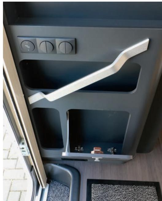
Les interrupteurs pour l'éclairage et le marche-pied ainsi que la solide poignée sont également bien positionnés.
