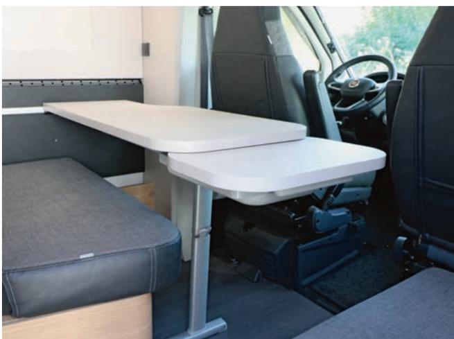
Une poignée permet d'agrandir la table jusqu'au siège latéral et au siège passager.
