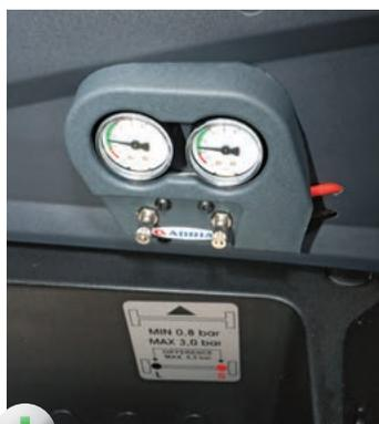
**+** Suspension pneumatique réglable sur l'essieu arrière.
